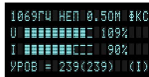
Рисунок 13 – Стабилизация по току
