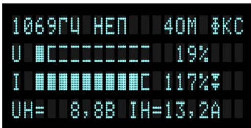
Рисунок 7.3 – режим ограничения по току (▼)
